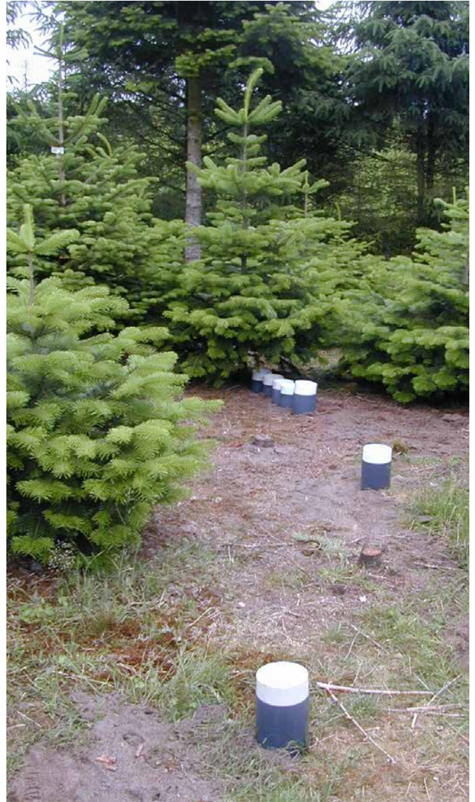
Måling af frilandsnedbør og nedbør under træer (gennemdryp).
