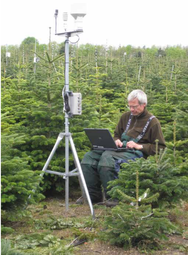
Tømning af klimastations datalogger. Maj 2009.
