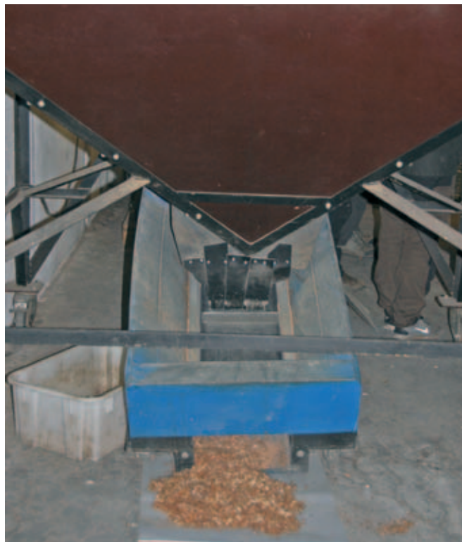
På lageret står forskellige maskiner til oprensning og tromler til afvingning af frøene. På rødgran og fyr er vinge og frø adskilt og kan sorteres, men på Abies hænger vinge og frø sammen og skal arbejdes af.
