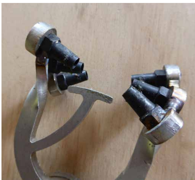
Figur 1. 2023-udgaven af TipTop-tangen som laver seks huller i en arbejdsgang. Hullerne laves i en skrå linje på topskuddet, så flere ledningsstreng gennemhulles.
