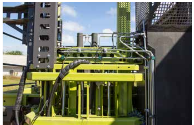
Alt fastsiddende hydraulik er udført i rør.
