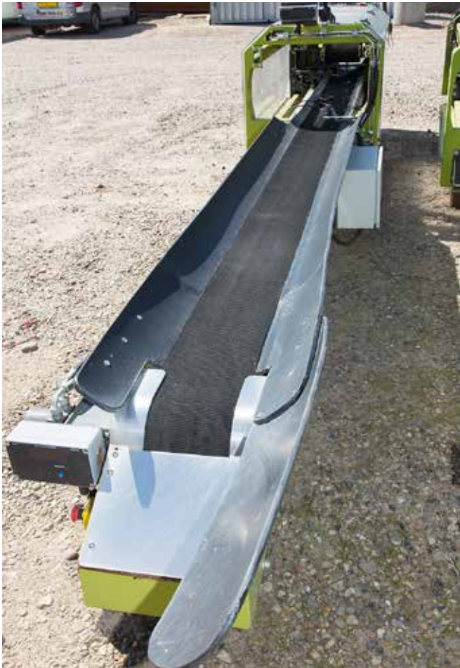
Træerne bliver via det lange gummibånd ført fra netmaskinen til pakkekassen, hvor der står en mand og lægger træerne på pallerne.
