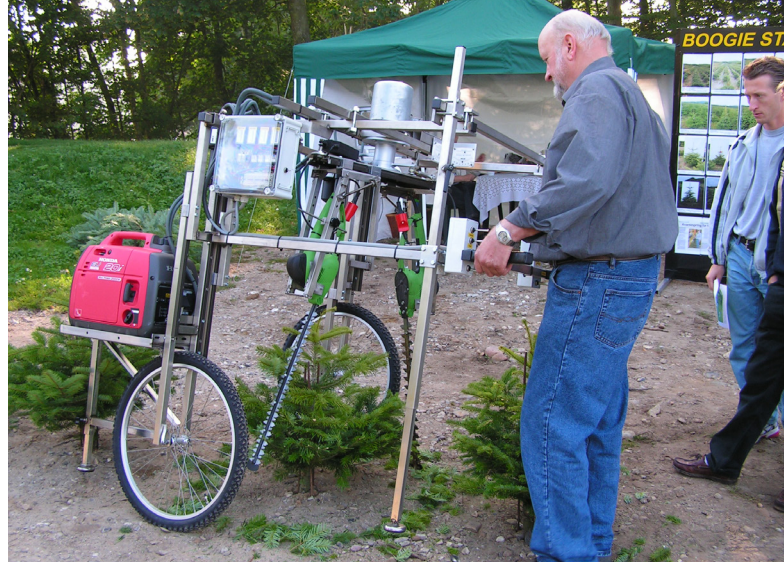
Tidlig prototype på en kegleklipper fra Niels Kjær Lauersen inklusive hækkesakse og cykelhjul.
