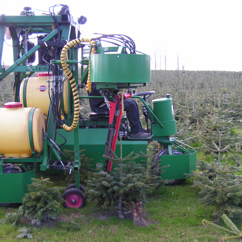
JUTEKs kegleklipper sat på en portaltraktor. Portaltraktoren som redskabsbærer var også i sig selv et kæmpe fremskridt.
