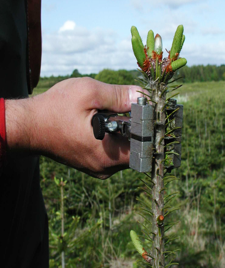
Lars Geils TopStop-tang. Opfundet for blandt andet at imødegå ønsket om en mekanisk og mere vejruafhængig metode til at regulere topskud.
