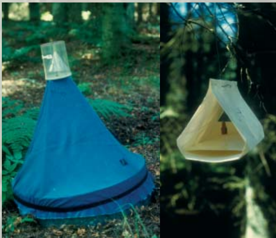
Figur 5. Tv. Klækkefælde hvor dyr, der kommer op af jorden og søger mod lyset, fanges af et slusesystem i opsamlingsglasset. Til højre en feromonfælde af Delta-typen. Feromonet ophænges inde i fælden, og en limbund fanger de tiltrukne hanner.
