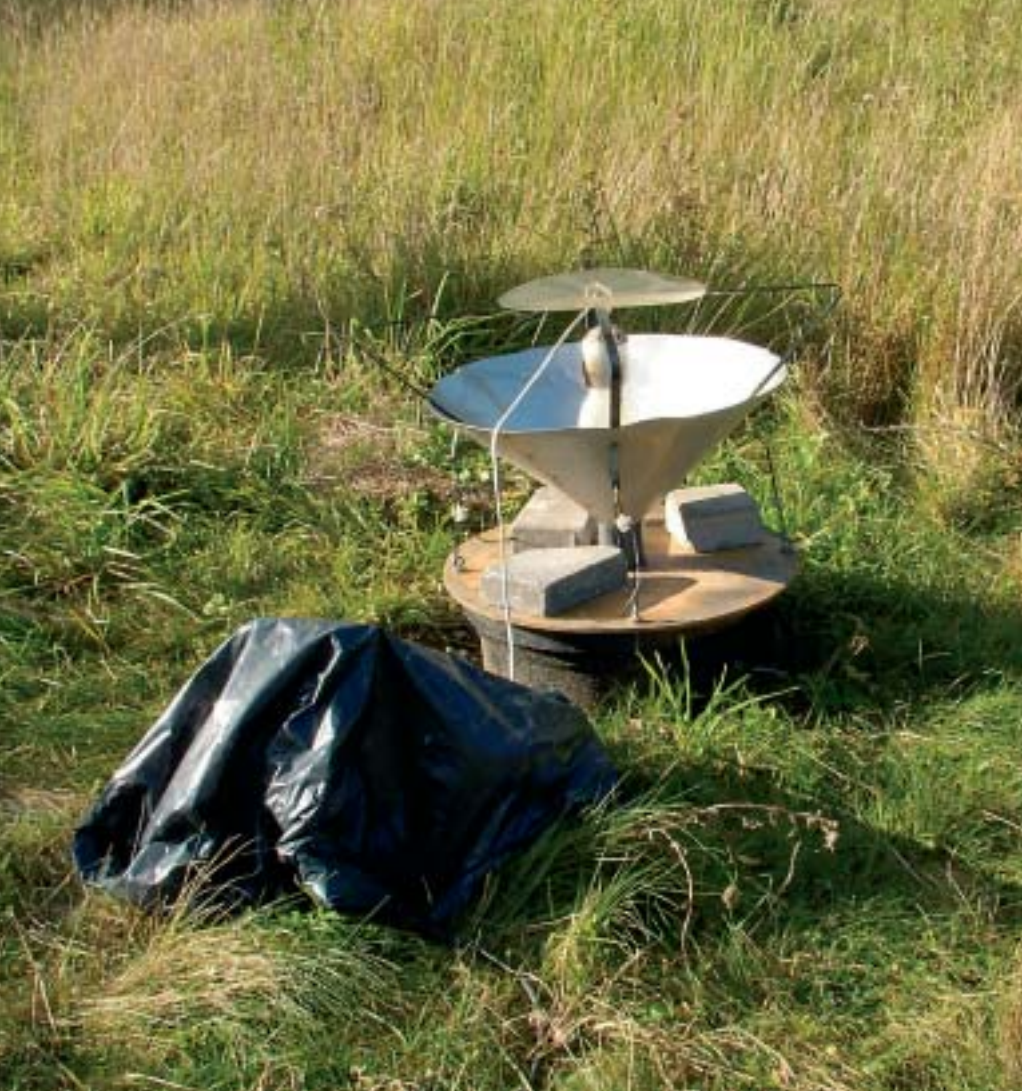
Figur 3. Automatisk lysfælde, som i juli 2005 blev opsat på Arboretet og tømt ugentlig i hele flyveperioden. Fælden består af en stor opsamlingsbeholder, som er delvis nedgravet. De overjordiske dele består af en kraftig lyskilde og en stor opsamlingsstragt. I opsamlingsbeholderen findes en gift, som dræber de fangne insekter.
