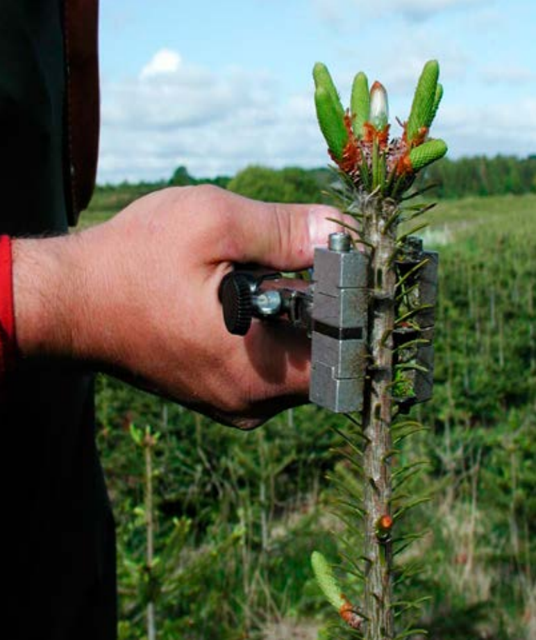
Lars Geils TopStop-tang. Opfundet for blandt andet at imødekomme ønsket om en mekanisk og mere vejruafhængig metode til at regulere topskud.
