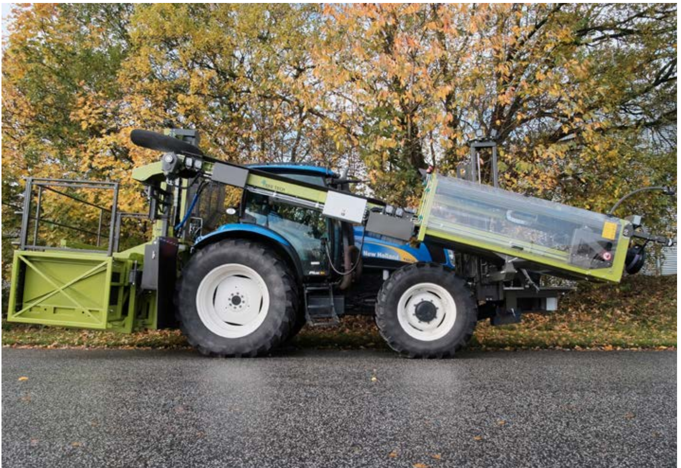
Tree Tech pakke- og netmaskinen er hydraulisk drevet af traktorens hydraulik.
