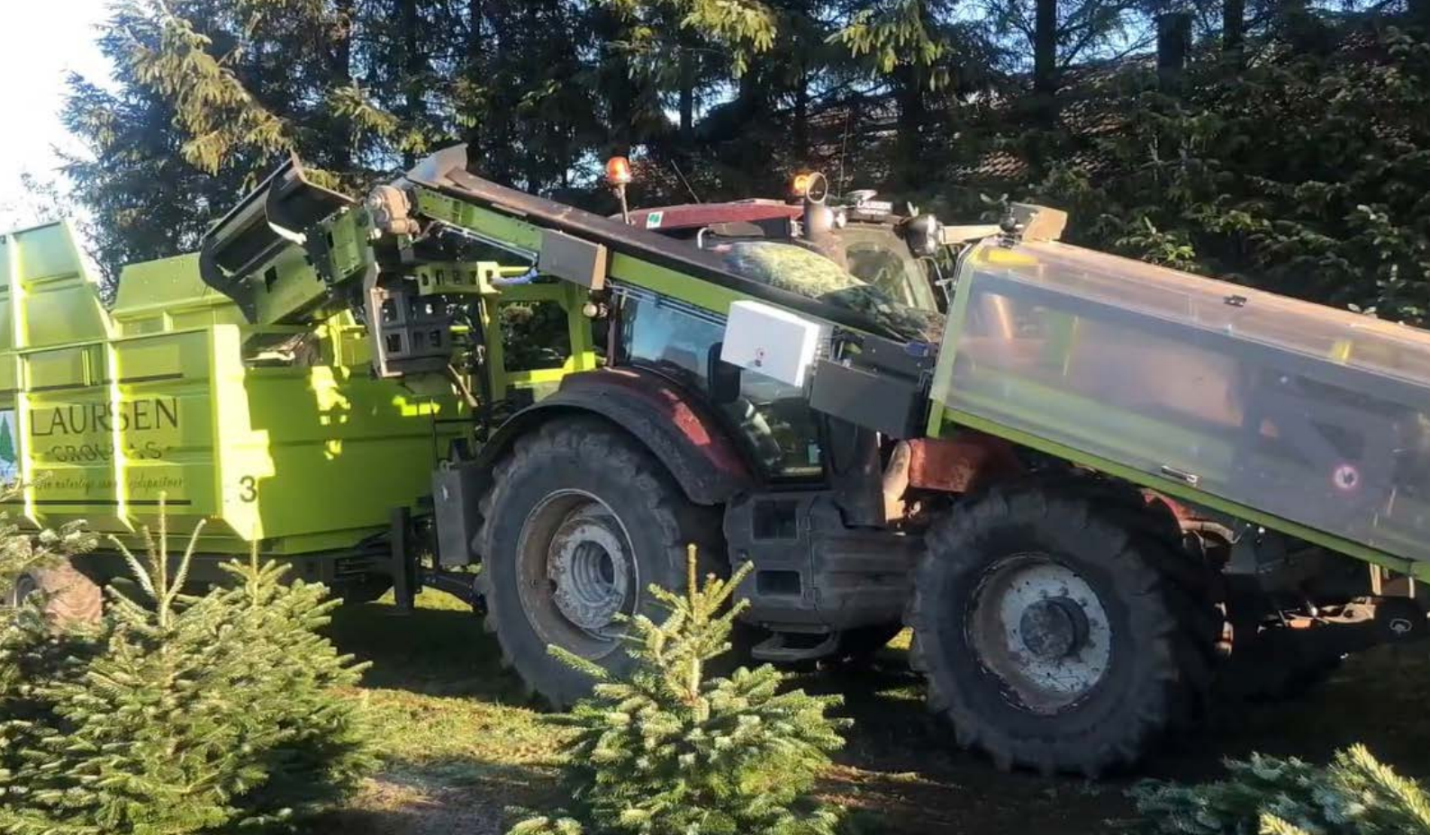
Bredsgaards løsning til at nette træer og køre dem på bånd op i en vogn.
