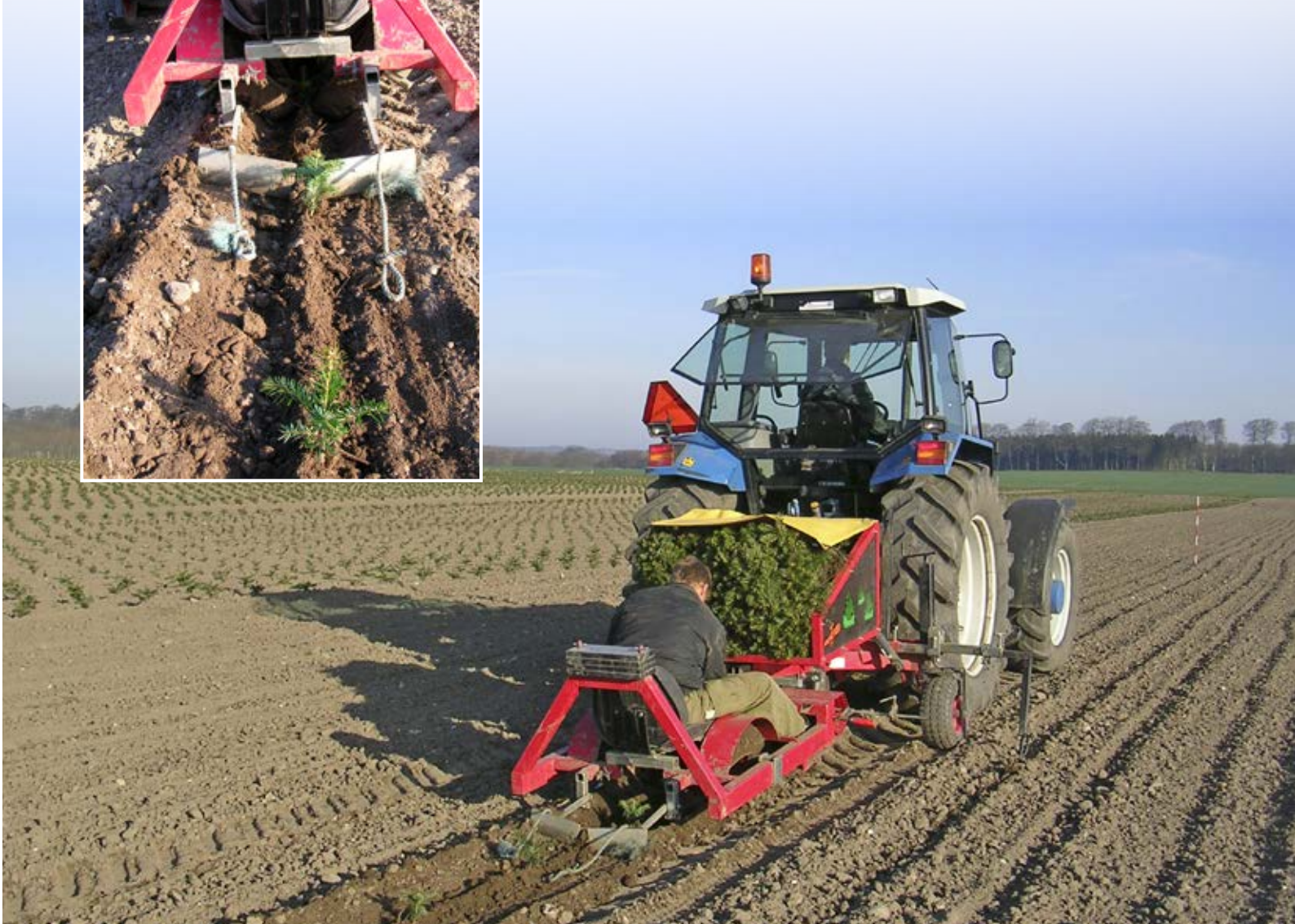
Plantning af nordmannsgran med en 1-rækket plantemaskine. Plantekassen er tydeligt afskærmet fra sider og top mod sol og vind for at beskytte planterne.
