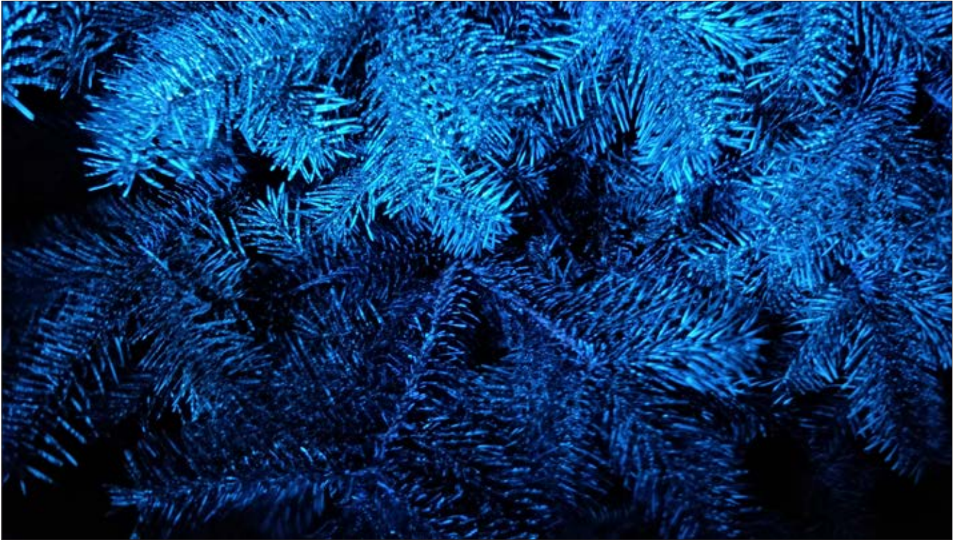
Fint sprøjteresultat opnået med dyser med grove dråber. Der er sprøjtet med fluorescerende væske, som så belyses med UV-lys.
