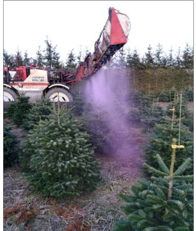
Kompaktdyser med luftassistance. Dette giver den bedste nedtrængning af sprøjtevæsken, men det giver ikke turbulens og dermed heller ikke luft med sprøjtevæske ind i træerne.
