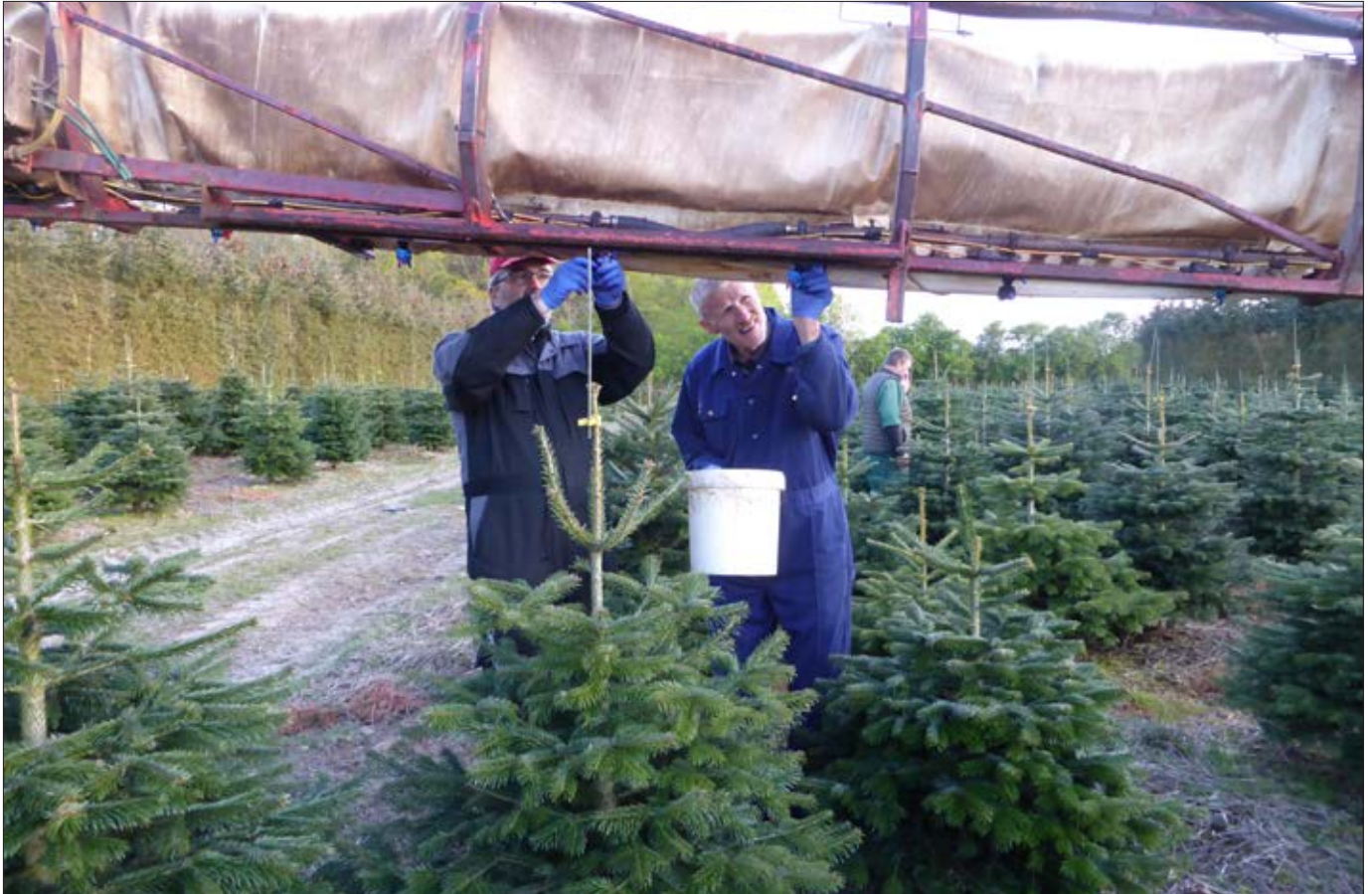
De to sprøjtespecialister Finn Søndergaard og Hans Thostrup i gang med at montere dyser til afprøvning på den store Knight-sprøjte.
