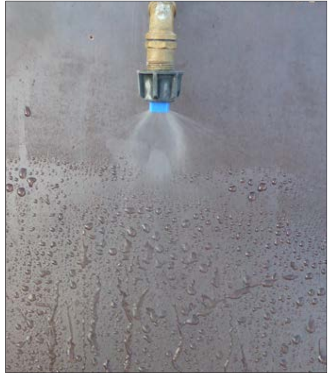
Almindelig fladsprededyse – det ses tydeligt, at viften består af meget fine dråber sammenlignet med kompaktdysernes grovere dråber.
