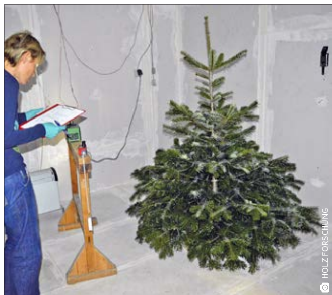
Opstilling af juletræ i modelrum på 30 m 3 med 23° C (± 2° C) og 50 % relativ luftfugtighed (± 4 %).
