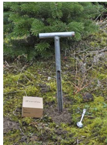
Udtag af jordprøver med stik, foretaget til 25 cm dybde efter at det overfladiske moslag forsigtigt er fjernet.
