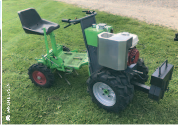
Figur 1. Hos to af demonstrationsværterne blev mikrokløveren sået i en allerede etableret nordmannsgrankultur. Hos Gorm Zinn i Vojens (t.v.), foregik jordbehandling og såning i én arbejdsgang. T. h. ses Søren Boysens selvudviklede Goliat kombimaskine til bl.a. udsåning af kløverfrø.
