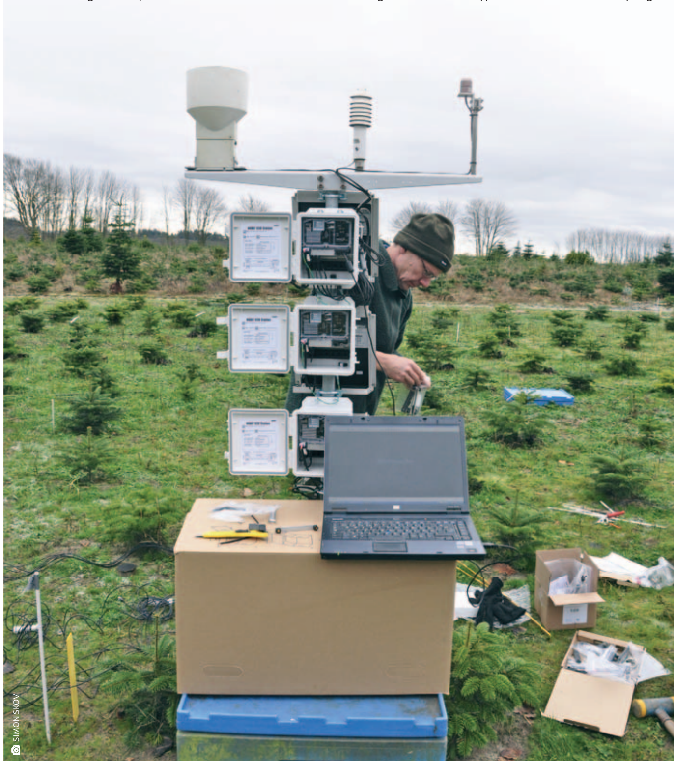
Med en lokal klimastation måles temperatur i to meters højde. Desuden logges der data fra de temperatursensorer, der er sat på træerne.
