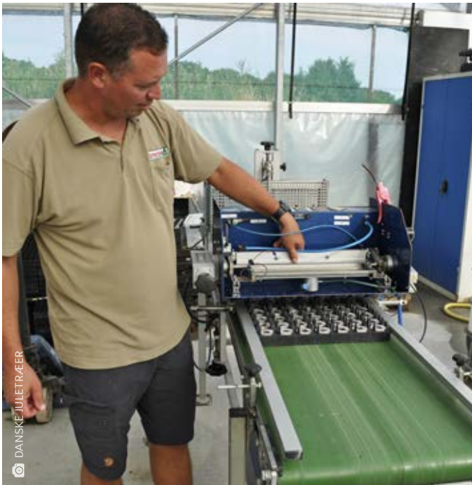
Den automatiske såmaskine, hvor frøene suges op enkeltvist for dernæst at blive sat i hver deres Jiffy 7 briket.
