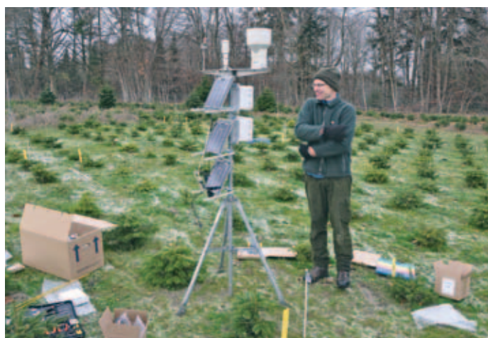
En del af instrumenteringen på forsøgslokaliteterne. T.v. forsøger Mads Krag at holde varmen under klargøringen af en soldrevet klimastation. T.h. etableres der et system af vaccumslanger i kulturen. Der suges jordvand fra jordsonder via slangene og frem til en opsamlingsflaske, der tømmer månedligt.
