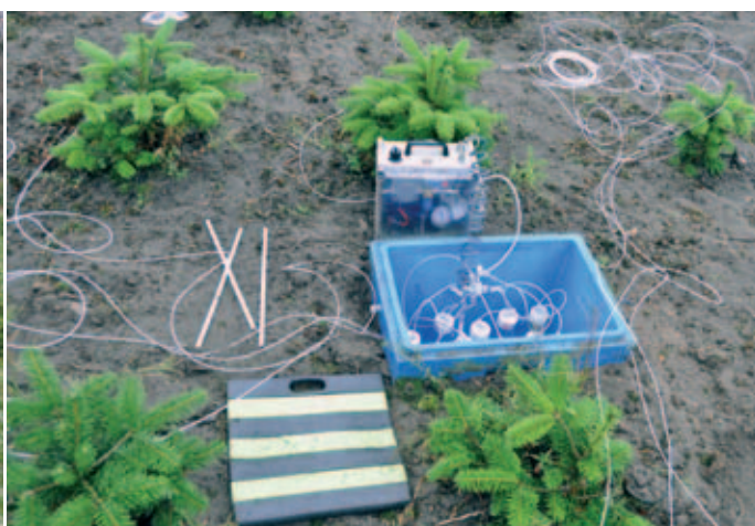
En del af instrumenteringen på forsøgslokaliteterne. T.v. forsøger Mads Krag at holde varmen under klargøringen af en soldrevet klimastation. T.h. etableres der et system af vaccumslanger i kulturen. Der suges jordvand fra jordsonder via slangene og frem til en opsamlingsflaske, der tømmer månedligt.
