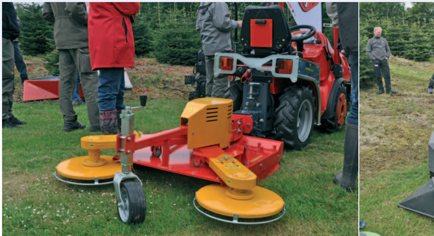
Rotorklipper fra Sønderup Maskinhandel til mekanisk ukrudtsbekæmpelse giver mulighed for et alternativ til den kemiske bekæmpelse.
