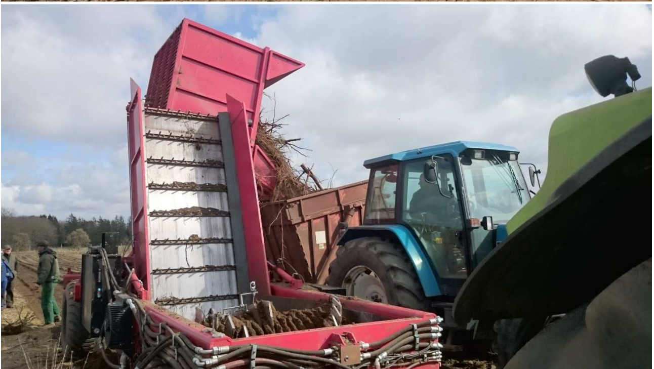
Stødrydning med maskine, som trækker stød op, ryster dem for jord og samler dem op i én arbejdsgang. Beholderen tømmes over i en vogn, når den er fuld. Fotos Niels Kjær Laursen
