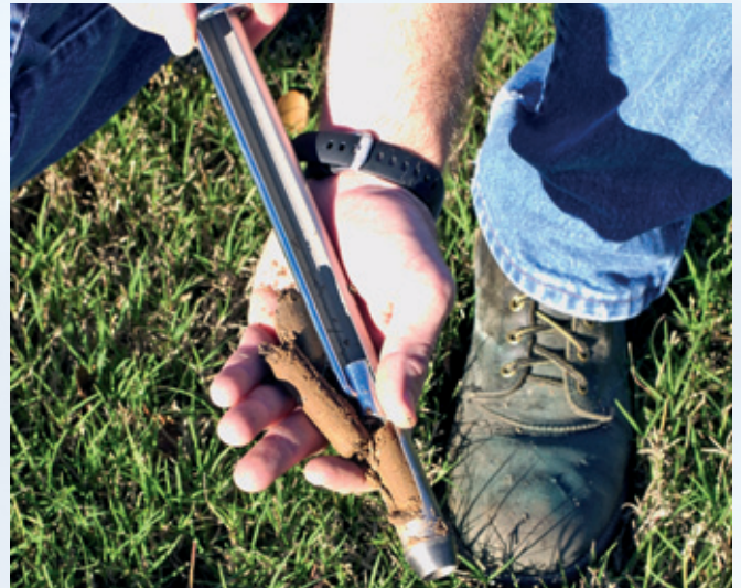
Der findes mange typer jordbor, nogen mere avancerede end andre. Her et jordbor fra Dansk Skovudstyr med monteret ske, som bruges til at trykke jordprøven ud, når denne er taget.
