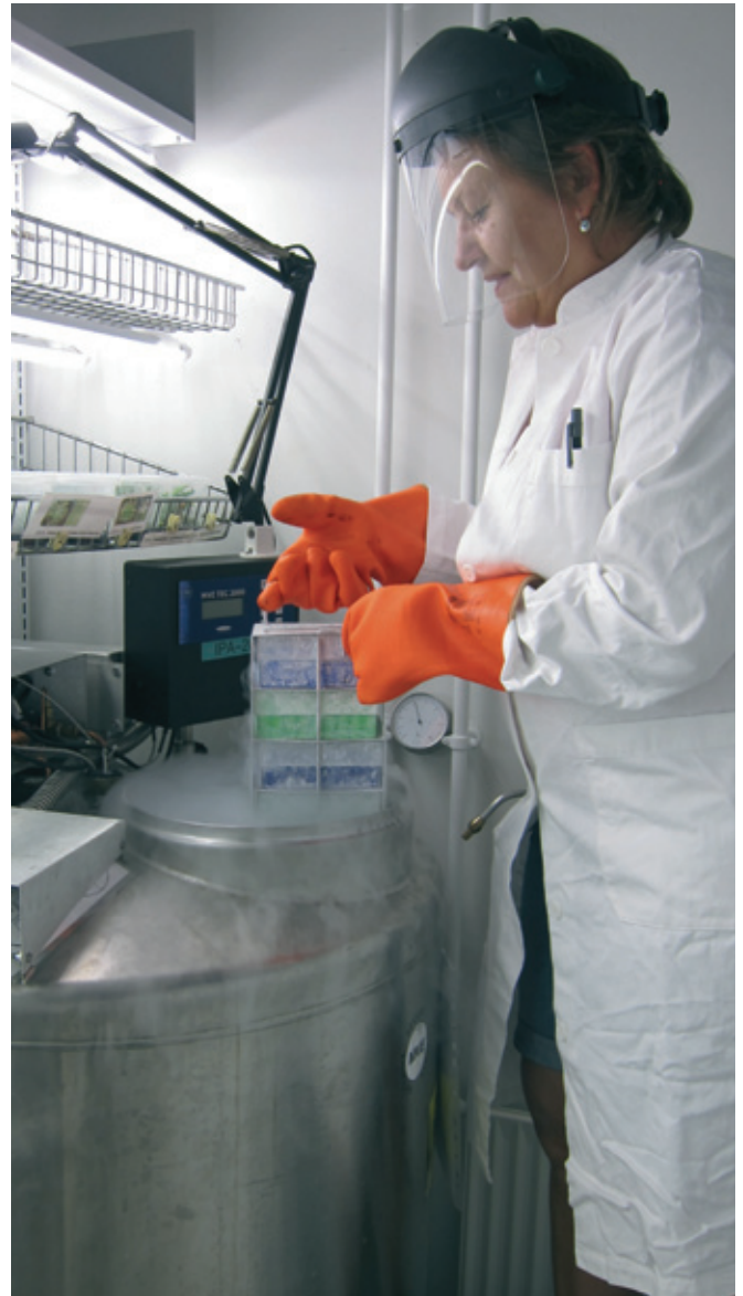
Figur 6. Genbank på IGN, Københavns Universitet. Alle genotyper opbevares i en genbank ved minus 196 °C i flydende kvælstof. Genbanken indeholder i øjeblikket cirka 900 genotyper af nordmannsgran. Derudover genotyper af nobilis og sitkagran . Genbanken er vigtig, fordi genotyper kan gemmes i lang tid, og kan blive optøet, når de skal bruges til produktion af planter.
