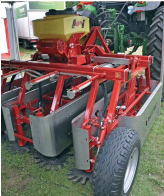
X-Weeder fra Groenoord på standen ved Damcon. Maskinen kan udføre mekanisk renholdelse, gødning og såning de første fire år i en kultur. De roterende gummiskiver med "fingre" river ukrudtet op og fordeler det ind mellem rækkerne, hvorefter det knuses. Under maskinen sidder en serie roterende knive, der findeler det oprevne ukrudt og udjævner jordniveaet i rækkel mellemrummene, så der ikke bliver dybe kørespor mellem rækkerne. Maskinen kræver dog, at traktoren tilpasses, så der er tilstrækkelig frihøjde til at køre i kulturen de fire første vækstsæsoner.
