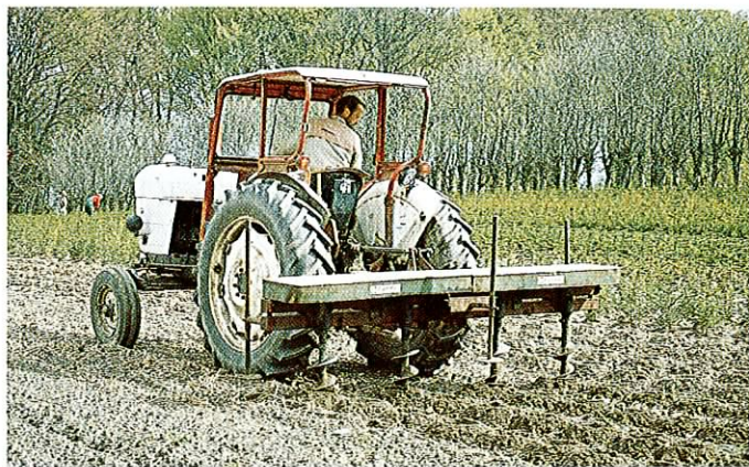
Figur 8. Der bores huller til plantning af juletræer. Rye Nørskov Planteskole.
