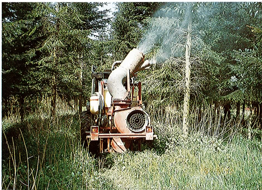
Figur 2. Lusesprøjtning med Hardi Combi 3 tågesprøjte.
