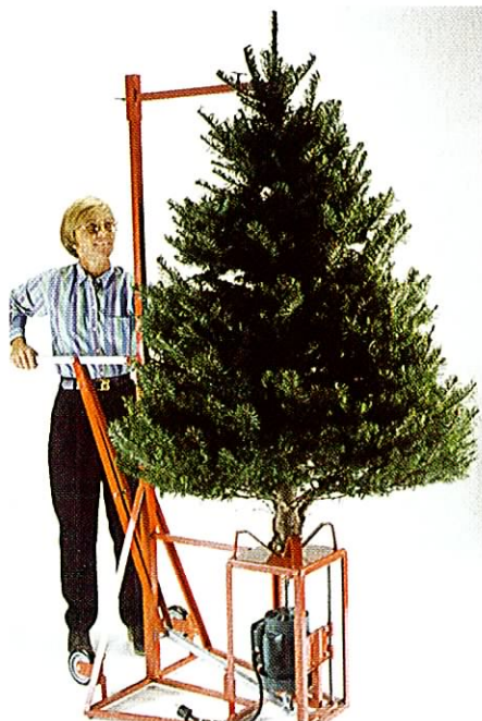
Fig. 3. Boremaskine til at bore et lige konisk hul i stabben af træet. Hullet er nødvendigt når træet skal anbringes i juletræs foden med vand på fig. 4.
