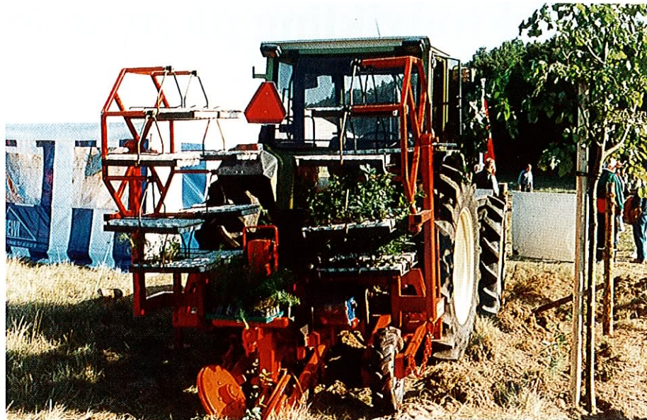
Fig. 2: Skovgående dækrodsplantemaskine. Planterne afleveres ved den lille røde bøjle midt for maskinen.
