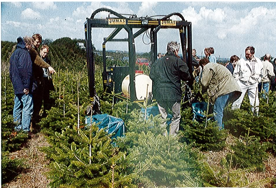
Figur 3: De fleste portaltraktorer kan også monteres med sprøjteudstyr. Her er vist Jumas' portaltraktor.
