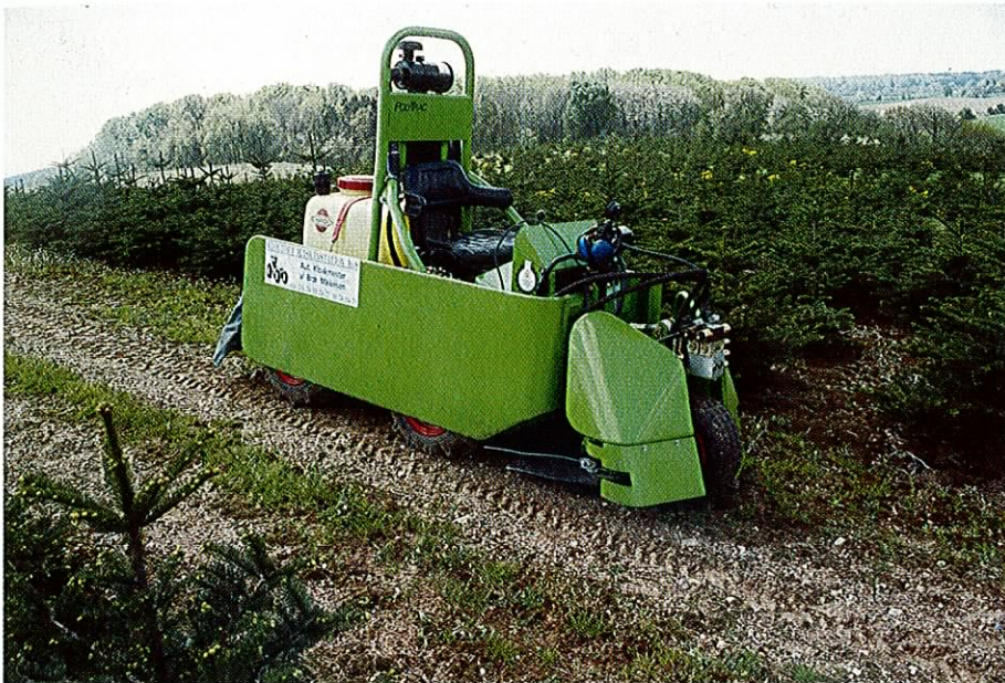
Figur 2: Med en rækkegående minitraktor er man ikke så afhængig af, om der er præcis den samme afstand mellem rækkerne, men der er dog et minimum. Her er vist "Snudebilen" fra Polytec.
