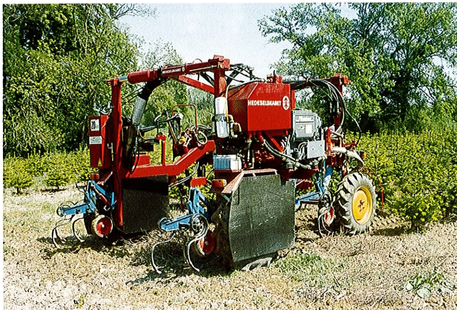
Figur 1: Specialtraktorer, muliggør mekanisk renholdelse indtil træerne er ca. 2 m høje. Her er vist Silvatecs Portaltraktor.
