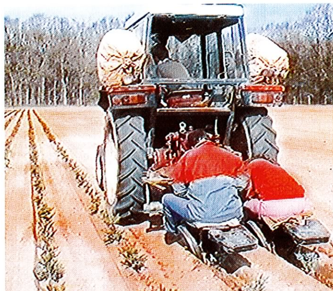
Figur 3: Maskinstationerne kan udføre arbejdsopgaver både tidligt og sent i en juletræskulturs liv. Her ses plantning med plantemaskine. Foto: Gammelskov Maskinstation.
