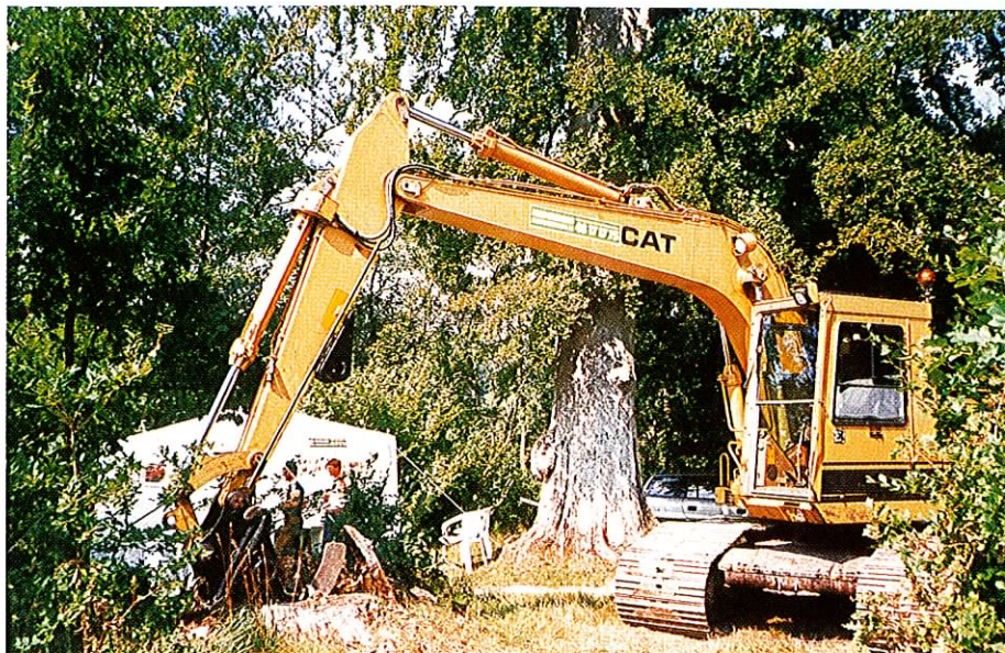
Figur 5: Entreprenørmaskine med rydningsaggregat kan fjerne gamle løvtræstød.
