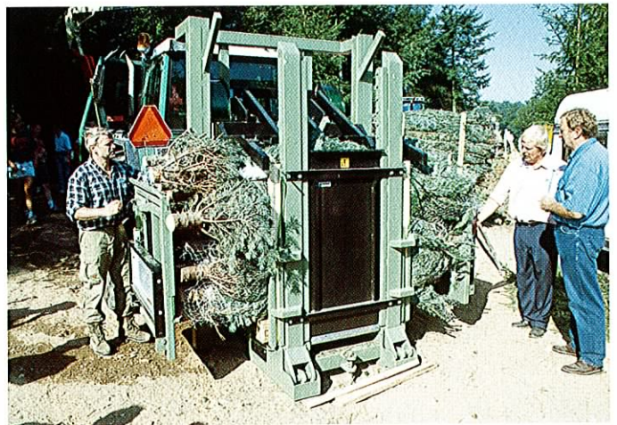
Foto 3. Træerne er læsset ind i kammeret, og den sorte bøjle komprimerer træerne. Herefter lægges to lægter øverst, og plasticbåndet strammes.
