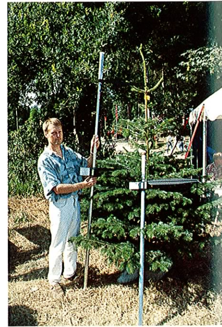
Foto 12. Datastangen bruges til opmåling af træer samtidig med registrering af kvaliteter, træarter mv.
