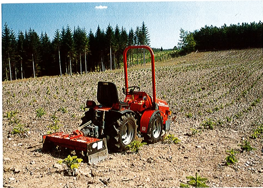
Foto 13. Fra forsøgsarealet med renholdelse - her parcel 3 med en Silvatec 4x4 mini med rotorharve.
