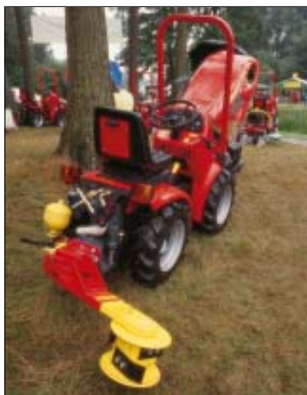
Figur 5. Egedal redskabsbærer, her med frontmonteret stabklipper og bagmonteret sprøjte.
