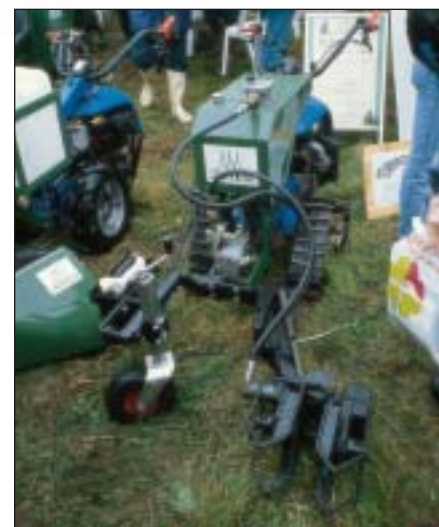
Figur 7. Jutek stabklipper på bæltetraktor, nederst til højre ses klippehovedet, der går ind på stammen og kører med rundt når traktoren kører frem. Under de to bøjler findes de to udvendige knive.
