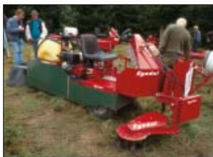
Figur 5. Egedal redskabsbærer, her med frontmonteret stabklipper og bagmonteret sprøjte.
