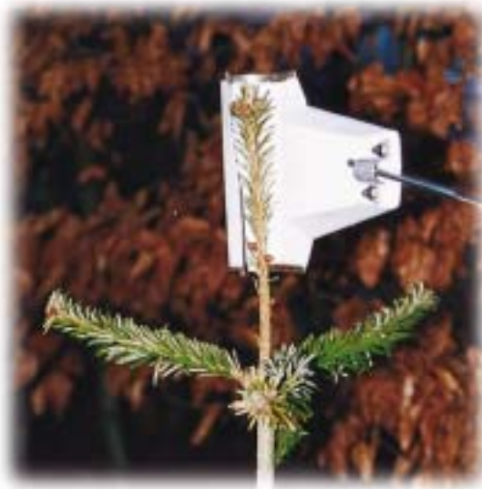
Figur 2 Eksempel på en skærm, der forhindrer sprøjtetågen i at blive spredt og herved forbedres arbejdsmiljøet for personen, som foretager udbringningen.
