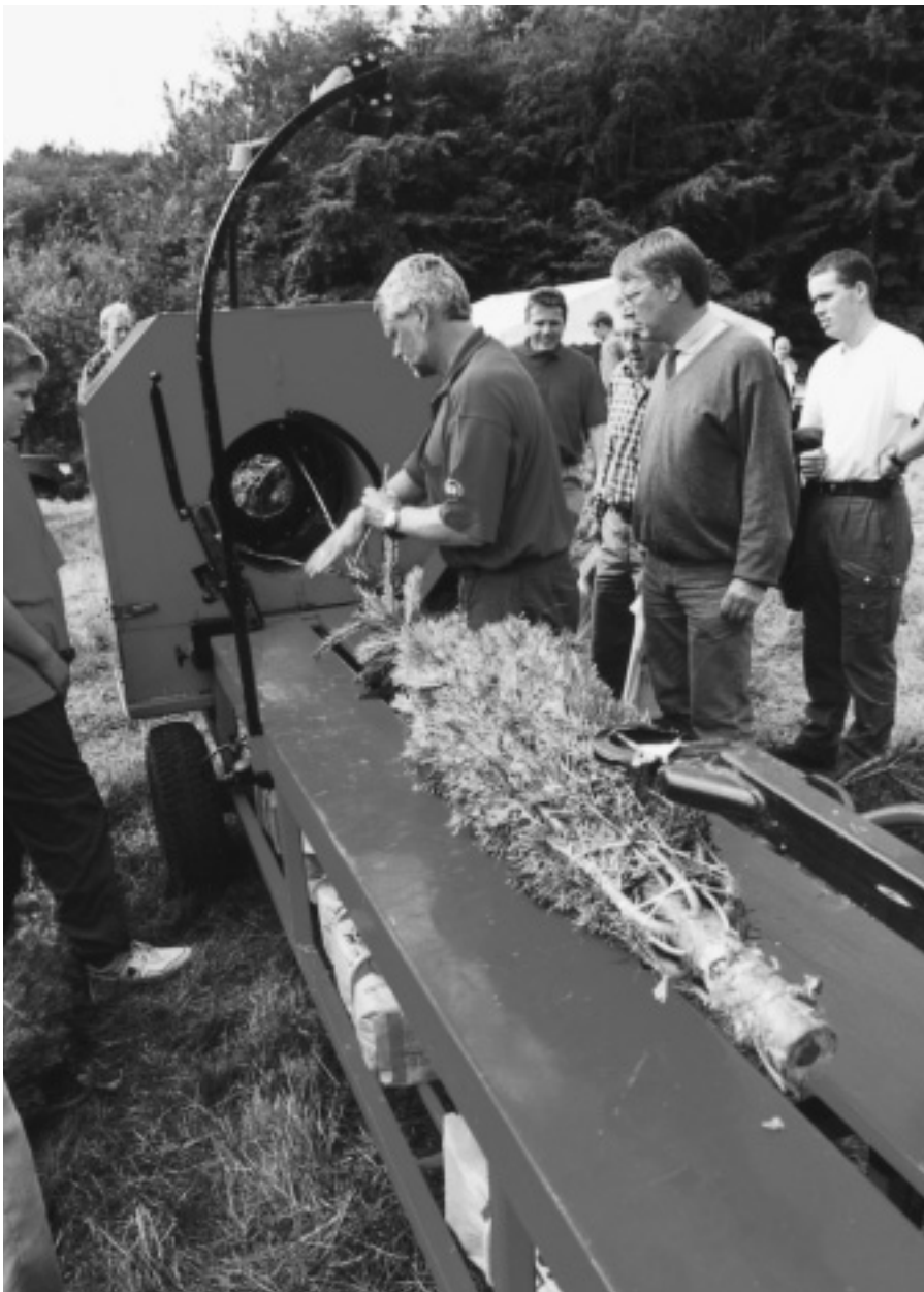
Prototype på snøremaskinen "Snore Bassen" fra Wefri i anvendelse. Her snøres med sisal.
