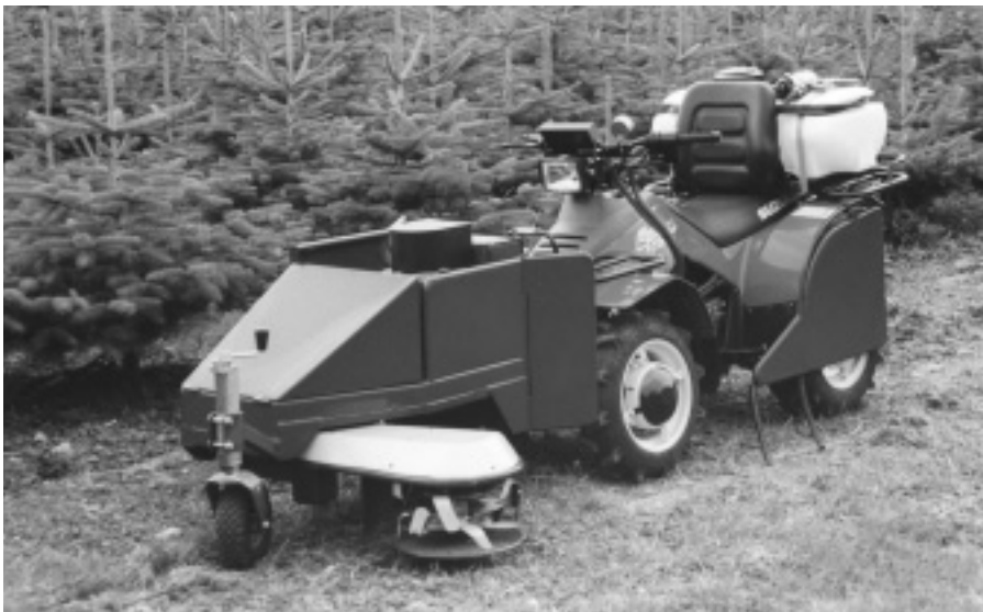
Suzuki minitraktor fra Ry Smede- & Maskinværksted med stabklipper foran og sprøjtebagpå.
