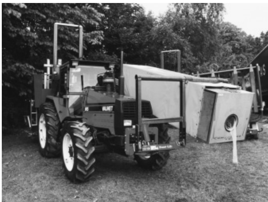
Prototype på kombineret netnings- og pakkemaskine fra CompacTree. Selve pakkemaskinen er ophængt bag på traktoren.
