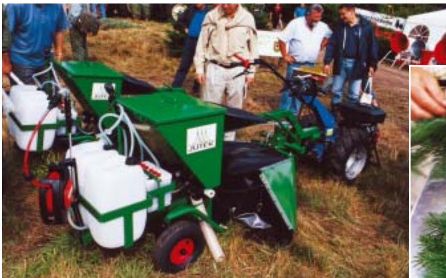
Tohjulet traktor fra Jutek med gødningsnedlægger og sprøjte.
