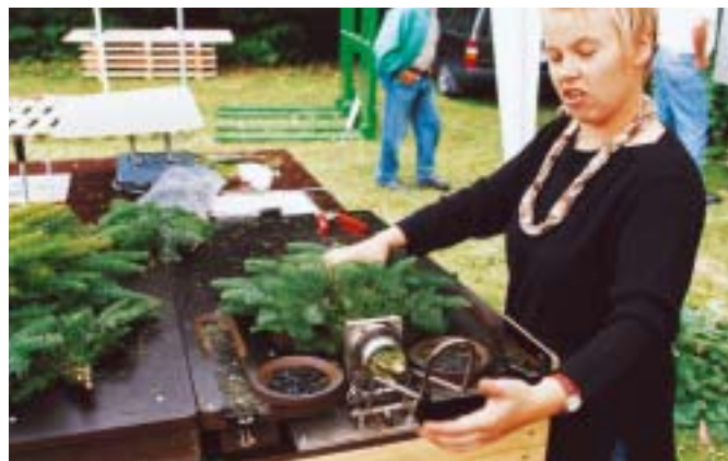
Maskine fra CompacTree til håndbuketter. Bundtet er ført ind i holderen, og med håndtaget til højre føres elastikken nu over på bundtet.
