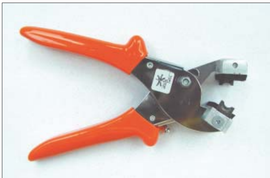
Top-Stop tangen med de to udskiftelige knive. Diameterskruen ses lige foran det nederste håndtag.
