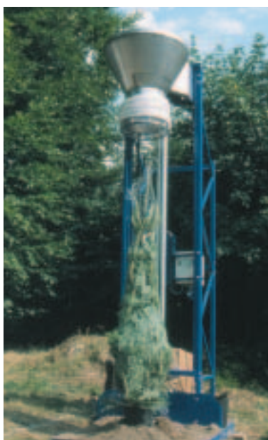
Det belgiske firma Sanac gav et bud på, hvordan man i en arbejdsgang kan forsyne afskårne træer med både en potte og et net.
