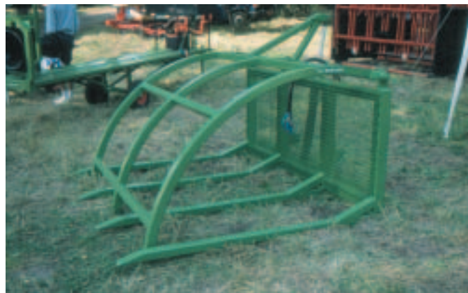
Den velkendte Lyn-Combi-Grab fra Plovfabrikken Bovlund er nu blevet forbedret, så styrken og levetiden er større. Det er et redskab, der har mange anvendelsesmuligheder indenfor skovbrug og juletræsproduktion.
