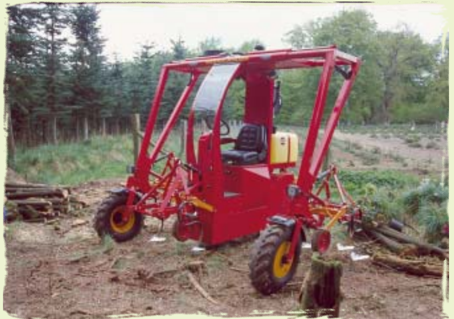
Den umiddelbare forbedring på Woodlander er vindskærmen til føreren, men der er sket en række ændre forbedringer herunder har maskinen fået tilført større trækraft. Den umiddelbare forbedring på Woodlander er vindskærmen til føreren, men der er sket en række ændre forbedringer herunder har maskinen fået tilført større trækraft.
