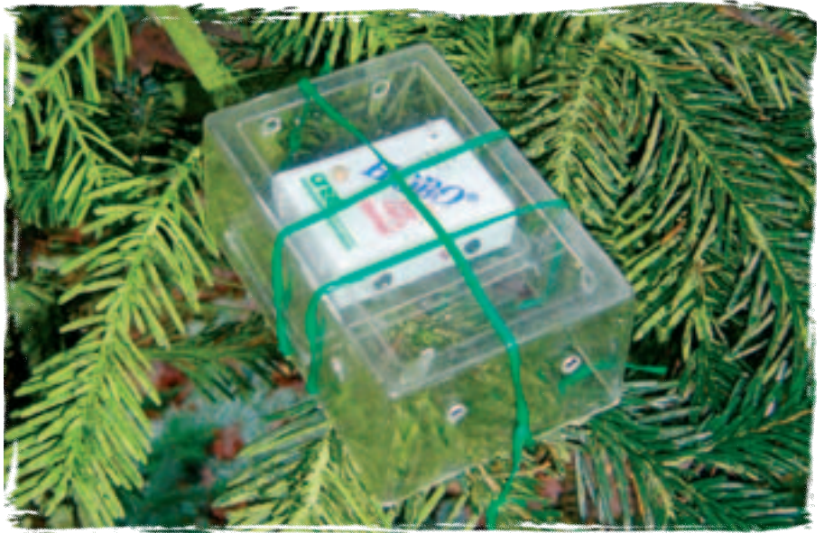
Datalogger sat på en gren med kraftige algebelægninger. Dataloggeren måler luftfugtighed, temperatur og lysintensitet over en lang periode. Foto: Niclas Bacher.
