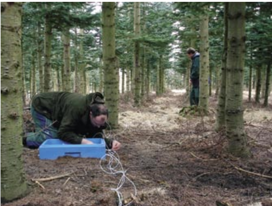
Figur 3 Der laves intensive undersøgelser af om gødningstilførslen kompenserer udtaget af næringsstoffer i nobilisproduktionen. På billedet instrumenteres jordsonder til måling af udvaskning under de højproduktive bevoksninger. Her på Næsbyholm hos Morten Nedergaard. Foto: Lars Bo Pedersen.
