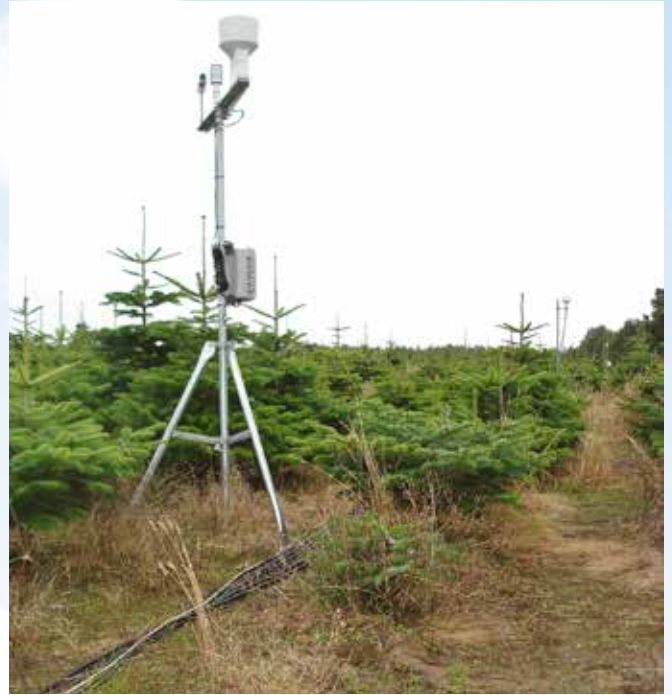
Den metrologiske målestation på Ry-lokaliteten (2007) i Agenda-projektet. I baggrunden ses flere målestationer, hvor der indsamles nedbør til efterfølgende måling og beregning af næringsstoftilførsel. Fra forsøg med behovsbestemt gødskning (Nåledrys 78 og 79), flisaske og gyllefibre (Nåledrys 80) samt forsøg med mærket kvælstof.
