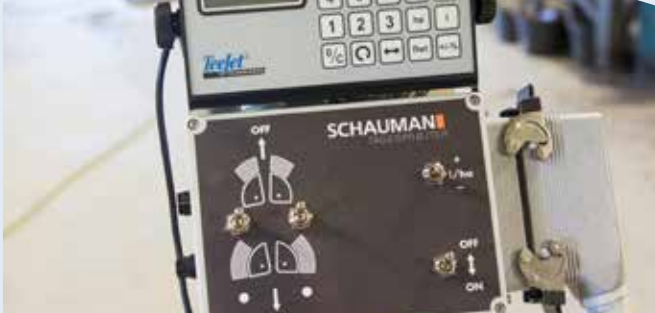
Her er den monitor, man kan købe som ekstraudstyr, så sprøjten kan betjenes fra traktorens kabine.
