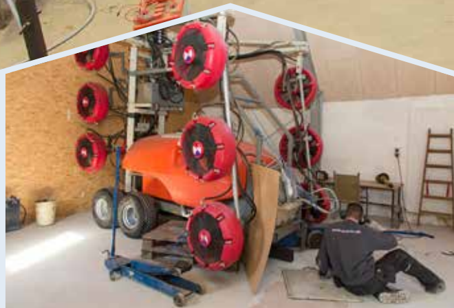
En stor og meget moderne tågesprøjte til brug i frugttræer. Den har en betydeligt større præcision end de traditionelle tågesprøjter.
