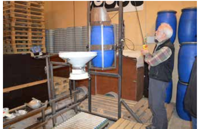
Hejsesystem til håndtering af stratificeringstønder så tunge manuelle løft undgås.
