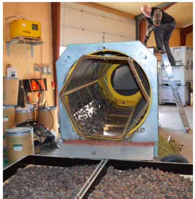
Tromlerensemaskine til såvel fjernelse af nåle og andre urenheder før klængning, som til selve klængningen af kogler efter de er åbnet i tørreovnen (i dette tilfælde er der tale om kogler af Bjergfyr (Pinus mugo rotundata)).
