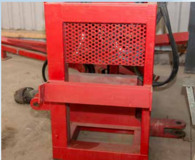
Dette er ophængt til sprøjtebommen, som monteres i traktoren trepunktsophæng, og som trækker den bugserede tågesprøjte.
