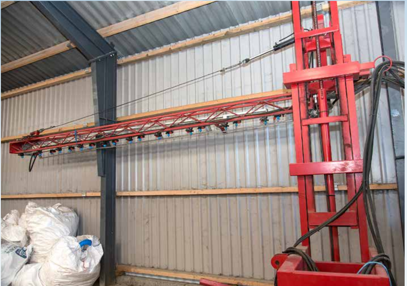
Her er den ensidige sprøjteboom, som bruges sammen med tågesprøjten. Det er en effektiv og prisbillig måde at have to sprøjter på.
