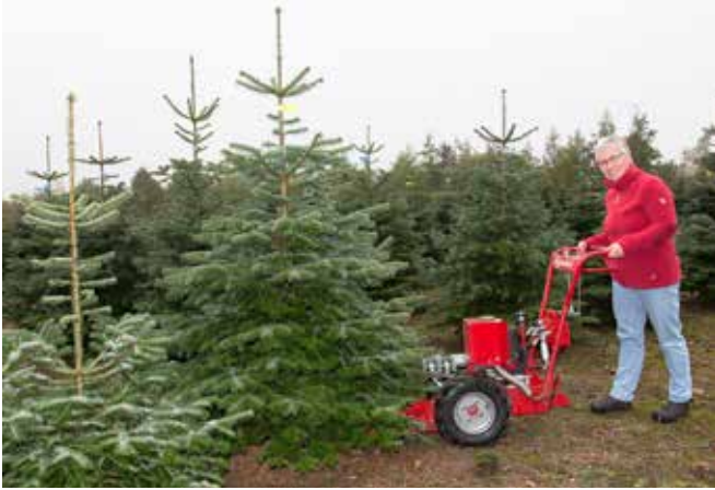
Else Andersen med den Egedal E2H juletræsmaskine, som hun fælder træerne med. Her kan man lægge mærke til, at udstødningen er ført frem til håndtaget, som den varmer op.
