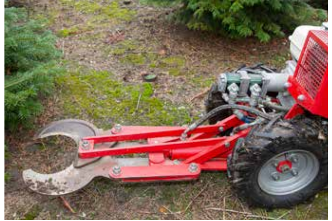
Det er en meget kraftig kniv, som tager træer med en diameter på op til 16 centimeter.
