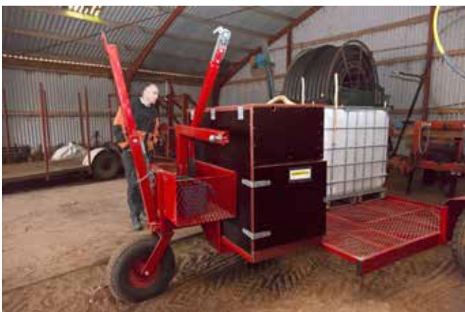
I stedet for at køre hjem efter vand og kemi har Christian Westh Andersen lavet denne vogn, han kan trække med ud i stykkerne med juletræer.
