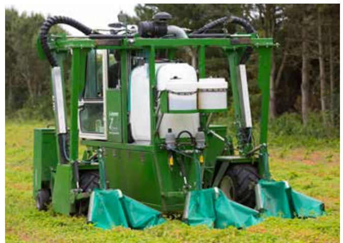
Når der bliver sprøjtet mod ukrudt med glyphosat, styrer X30 konsollet både dosering og hvor, der bliver sprøjtet. Den ved, nemlig hvor markkanterne er og hvor, der allerede er sprøjtet.
