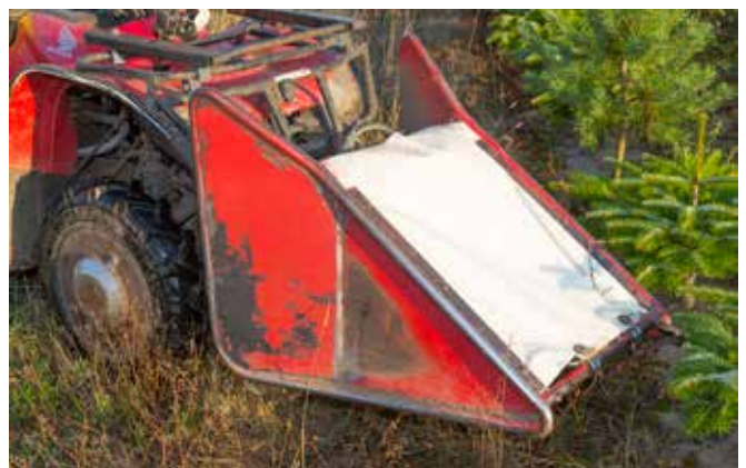
Der kan være lift både foran og bag på ATV'en.
