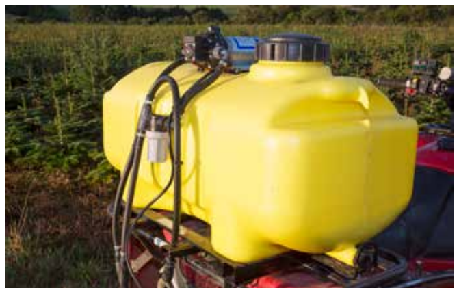
Tanken til væske er sat fast på bagagebæreren, og den rummer 95 liter og har en pumpekapacitet på 7,7 liter i minuttet.
