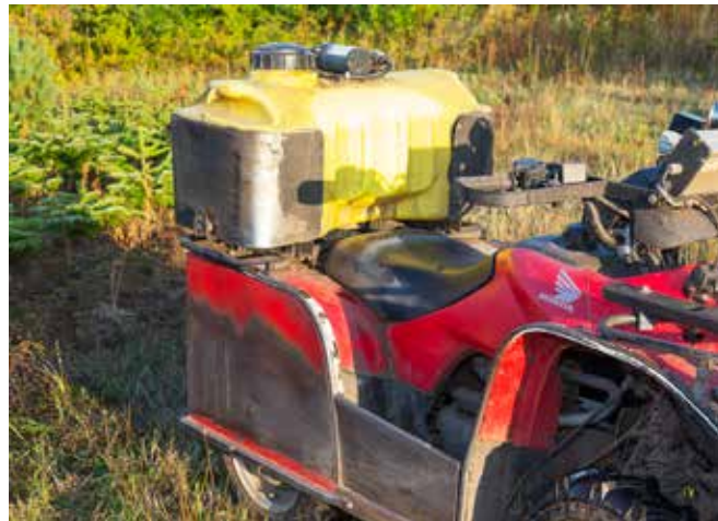
Læg mærke til, at det hele maskinen er beskyttet af skjolde, og de beskytter selvfølgelig også føreren.
