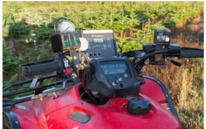
Betjeningen foregår her ved styret og sprøjtecomputeren, som sidder i midten. Blandt andet kan man få et injektionssystem til sprøjtning, så der kan pletsprøjtes effektivt med kort reaktionstid.
