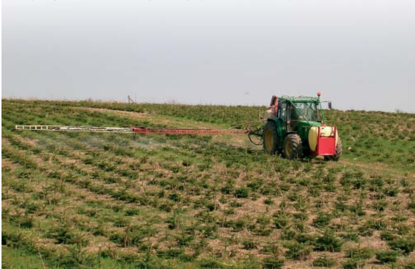
Foto 1. Ukrudtsmidlerne blev bragt ud med en 12 meter lang bomsprøjte. Foto: Jan Jürgensen
