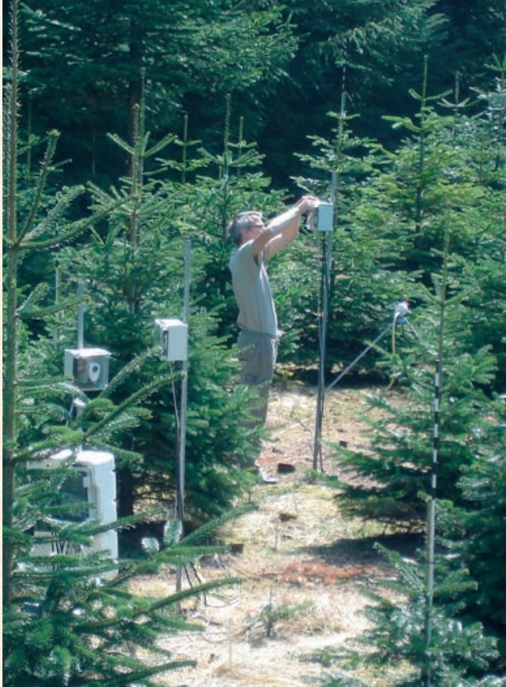
Foto 2. Klargøring af webcams, fotohuse og måletræer til den kommende sæson. Bemærk målepindene på måletræerne. Foto: Lars Bo Pedersen
