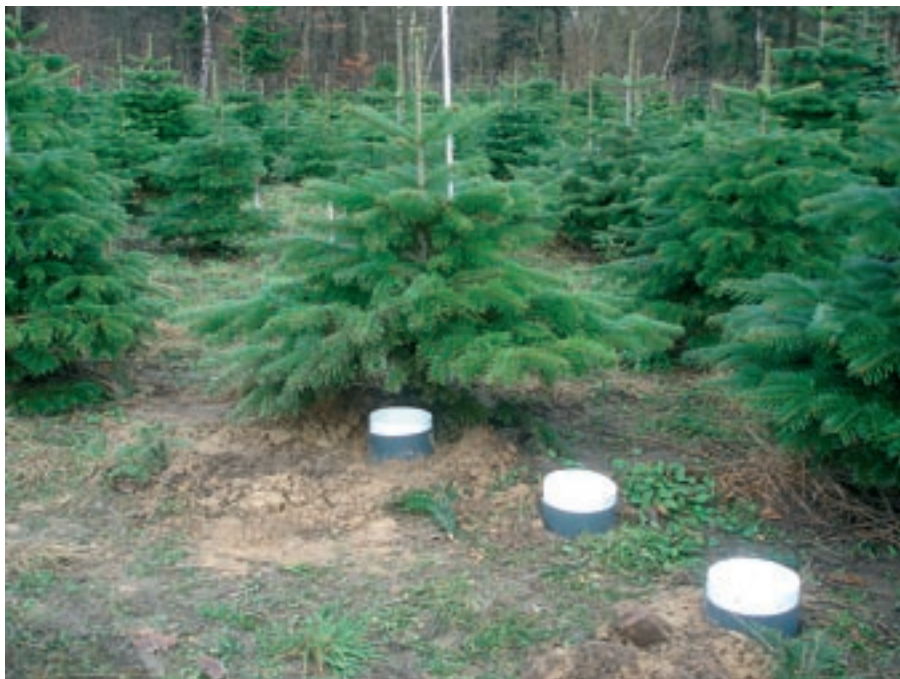
Foto 3 Etablering af flere type tragte til opsamling af regnvand er nødvendig for at beregne en korrekt vandbalance. Der er etableret tragte i forskellige afstande til træerne, både inden under træerne, i dryplinien, og i det fri. Der er også etableret flere tragte i 2 meters højde fri fra træernes påvirkning.
