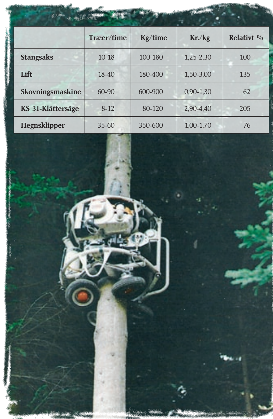
Figur 1 Nedklipping med KS 31-Klättersäge
