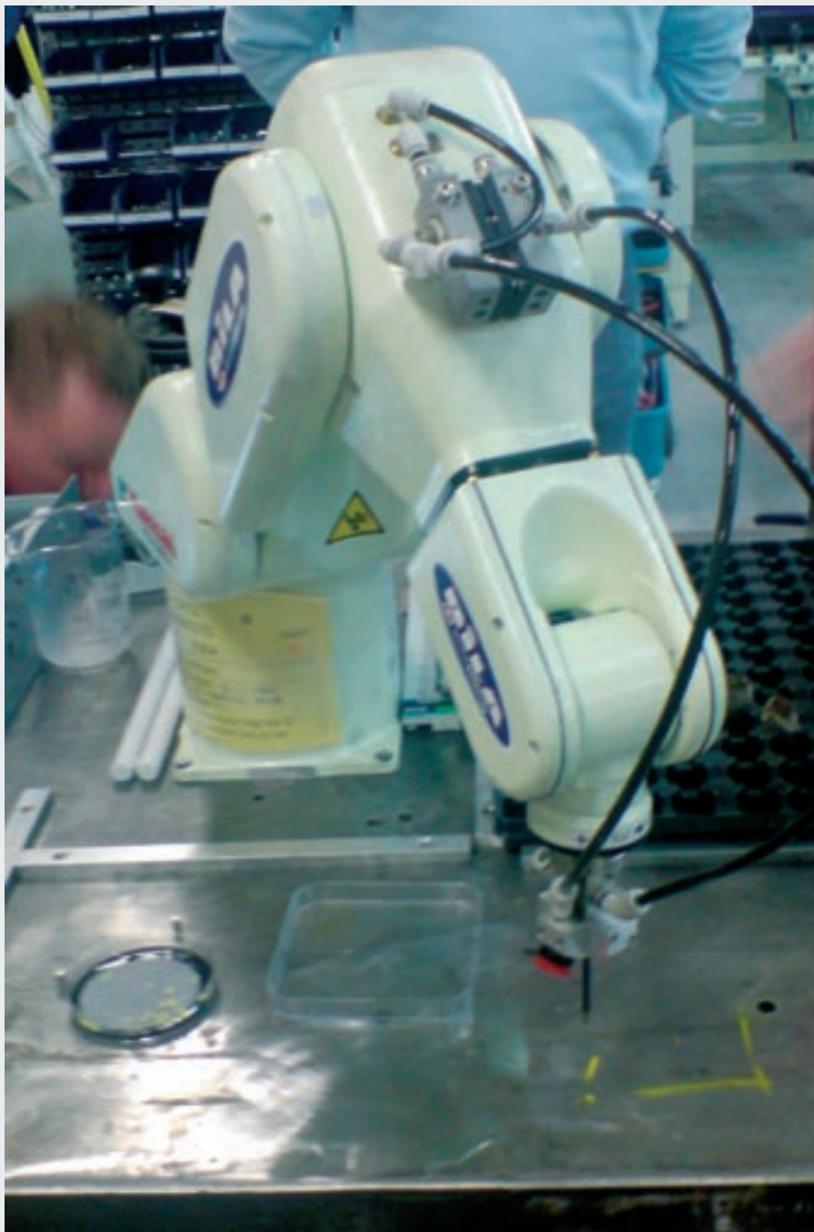
Figur 3. Robotten skal udføre to forskellige processer, som er meget arbejdskrævende i planteproduktion ved kunstig kimdannelse. I den første proces skal den kvalitets-sortere kim og flytte dem over på et spiremedium. I den anden proces skal den kvalitets-sortere spirede kim og prikke de bedste over i et plug-system. Målet er at håndteringen af hver plante ikke må tage mere end 5 sekunder. Billedet er taget under en prøvekørsel hos BILA A/S, der står for udviklingen af robotteknologien.
