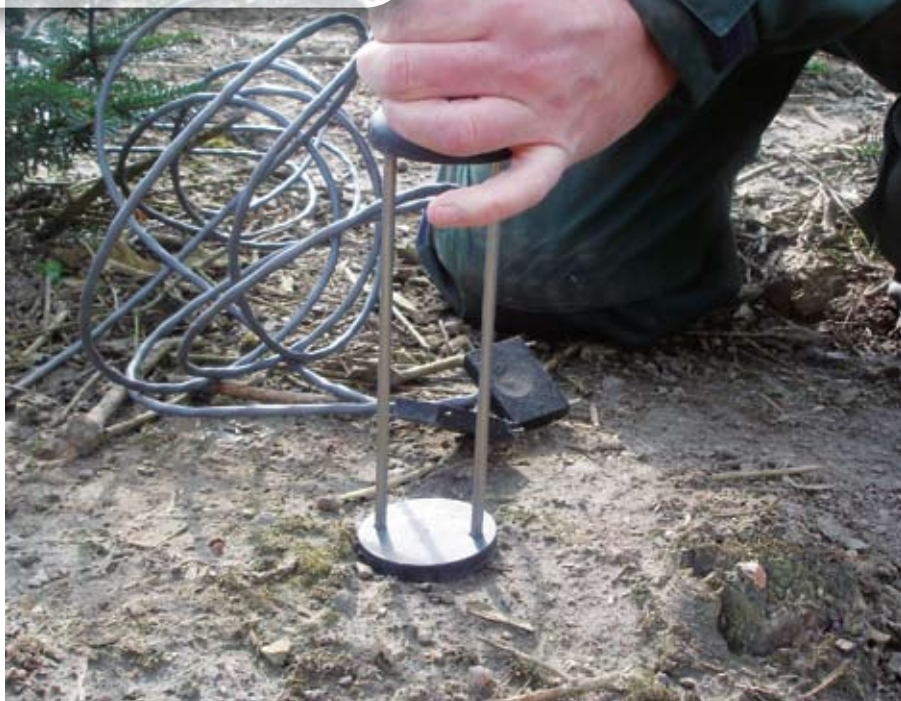
Foto 3. Jordfugtigheden måles ved hjælp af TDR-teknik. To jernstænger monteres så de strækker sig fra jordoverfladen til 60 cm dybde. Stængerne forbindes via et kabel til en opsamlingsstation (lille billede) der så er forbundet til forsøgets computere og modem (se indsatte billede i foto 1), der løbende sender data til Skov & Landskab (KU) via telefonnettet. Jordfugtighedsmålingerne foregår hver anden time ved at måle svækkelsen af et elektrisk signal, der sendes ned igennem de parallelle jernstænger. Vandindholdet i jorden er proportional med svækkelsen af det elektriske signal. Fotos: Lars Bo Pedersen.
